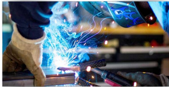
Şekil 2.6: Örtülü elektrot ark kaynağı [12]
