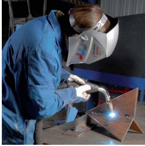
Şekil 2.1: Gaz metal ark kaynağı [8]
