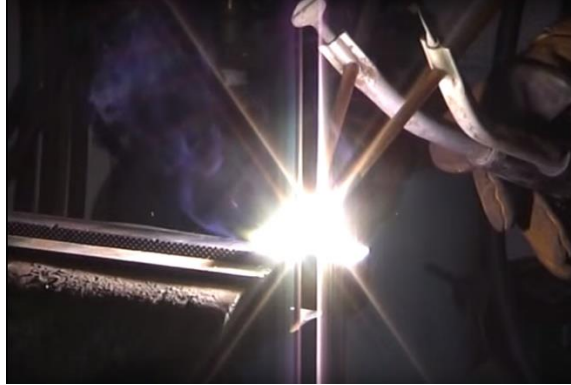
Şekil 2.4: Karbon ark kaynağı [10]
